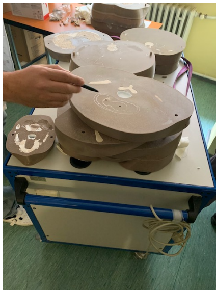
Slika 2. Slojevi fantoma sa šupljinama u koje se mogu postaviti dozimetri radi mjerenja ozračenja. Fotografirao autor.
