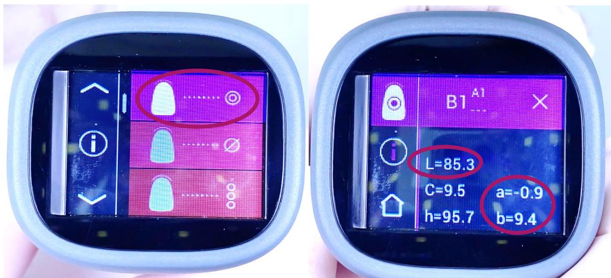
Slike 9 i 10: Funkcija mjerena pojedinačnog zuba i prikaz dobivenih vrijednosti mjerjenjem
