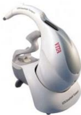
Slika 2. Spektrofotometar VITA Easyshade compact (Vita Zahnfabrik, Bad Sackingen, Njemačka) (CC BY)
